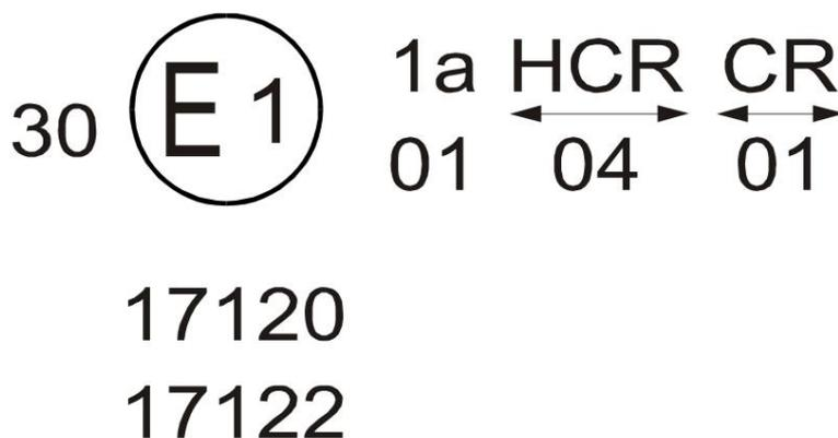
L'exemple ci-dessus correspond au marquage d'une lentille destinée à être utilisée dans différents types de projecteurs, à savoir :
